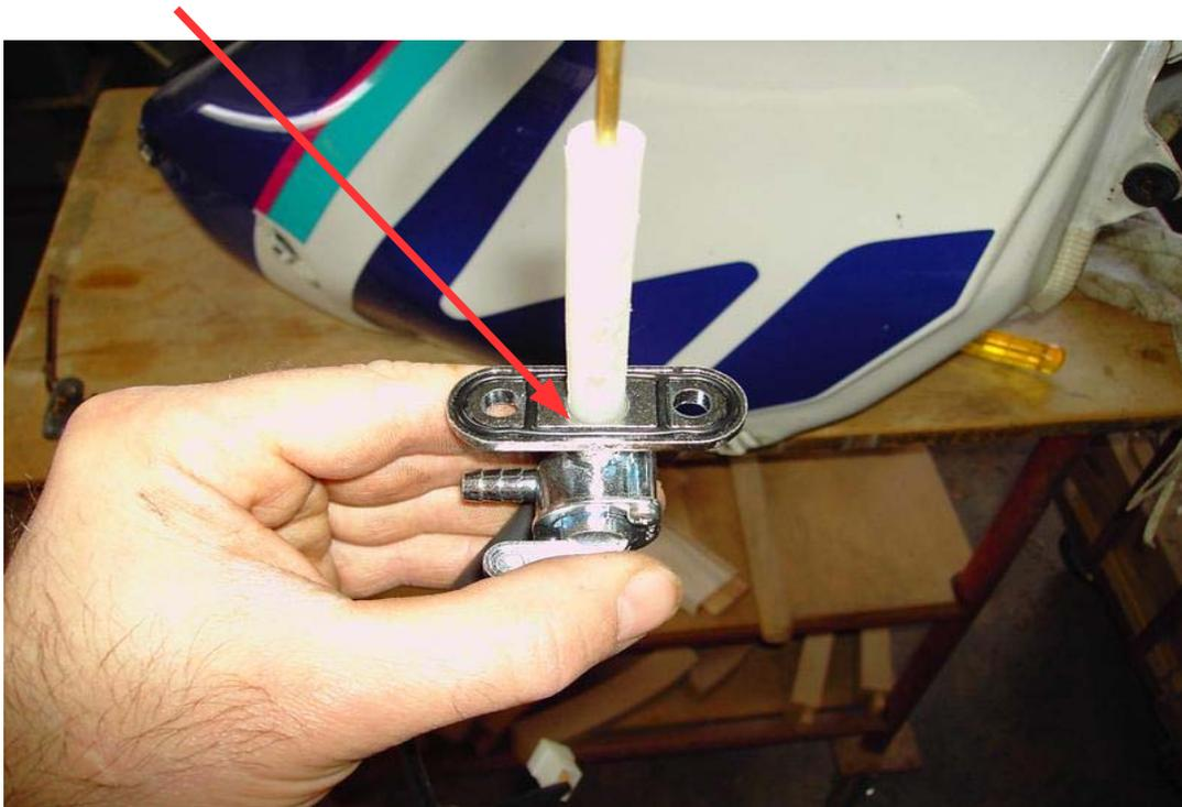
Ho piegato leggermente l'astina del galleggiante perché non vada ad urtare la parte interna del serbatoio, muovetelo lateralmente quando l'avete infilato per essere sicuri che il galleggiante sia libero.
