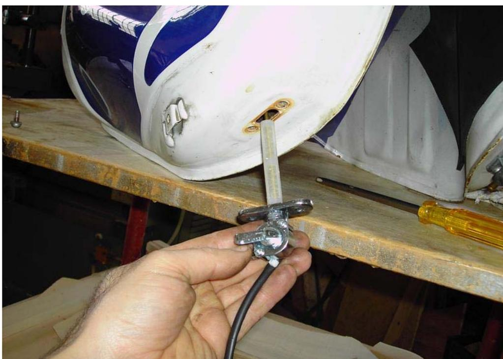
La vite sopra il beccuccio porta gomma va cambiata con una esagonale, perché essendo perpendicolare al foro con il cacciavite non si riesce a avvitare la vite (quello originale è disassato e il cacciavite ci passa) quindi vite da 6 mm testa da 10mm
