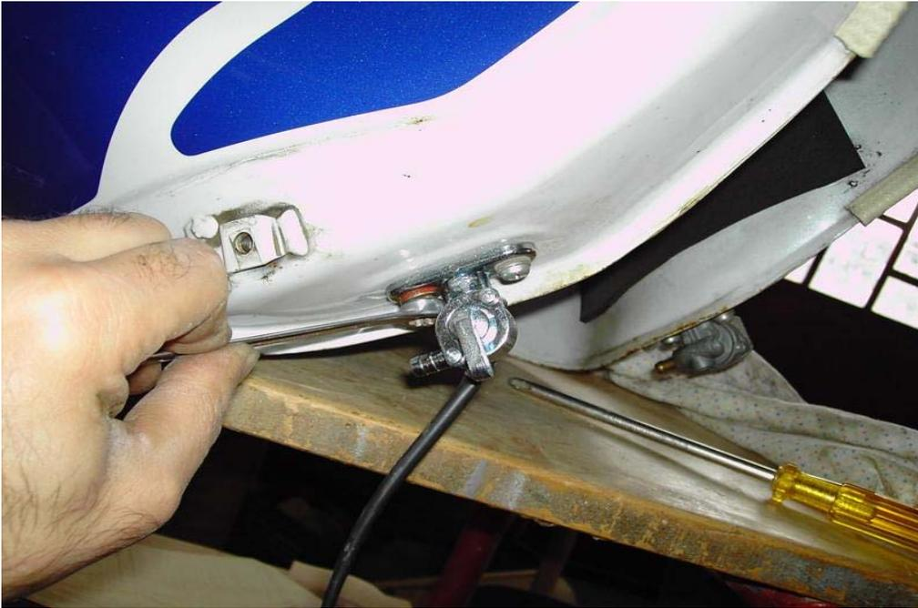
Si posiziona il cavo in dotazione facendolo passare a fianco della guaina dello starter continuando fino al quadro strumenti.
