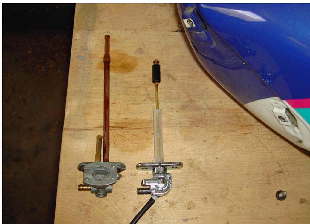
Mettete la guarnizione nuova che viene fornita con il kit
