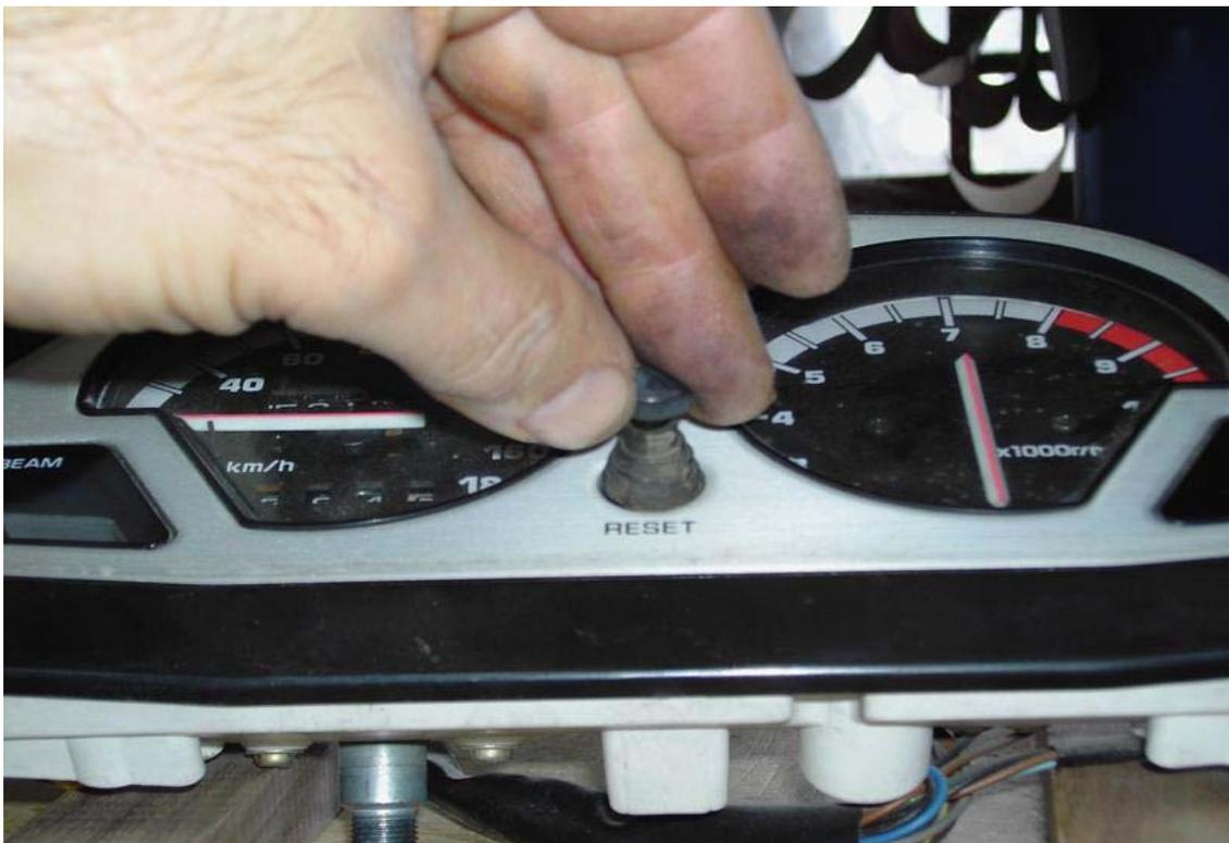
Avremo così il cruscotto aperto, dobbiamo trattarlo con molta cura per non rovinare gli strumenti. Come si vede io ho tolto il coperchietto di dx di un foro libero ma chi vuole può togliere quello di sx è la stessa cosa (i coperchietti sono di plastica nera).
