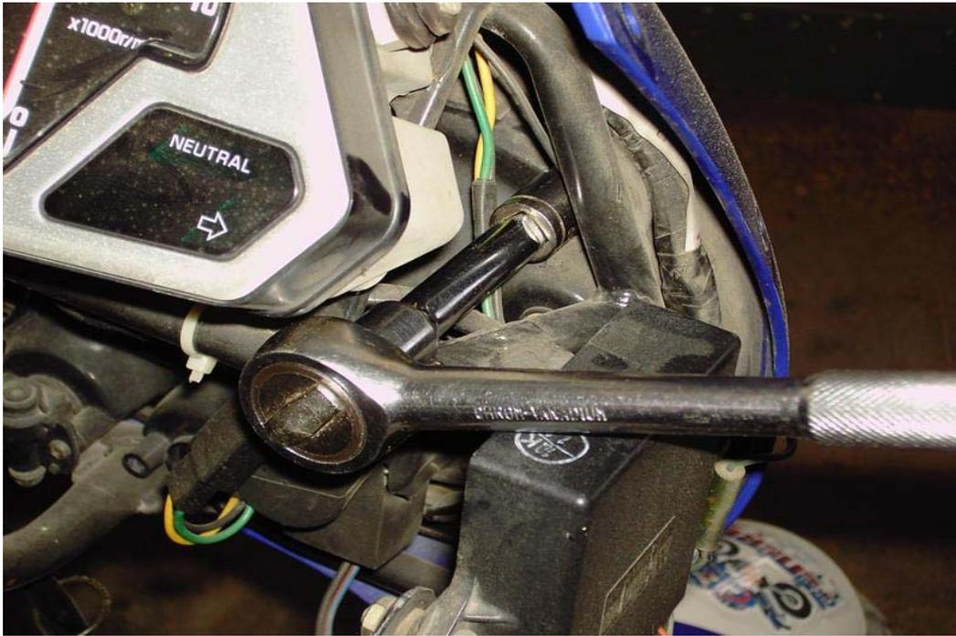
Si svitano i due bulloni che tengono fissato il cruscotto ,si stacca la serpentina del conta km e il connettore dei cavi elettrici .
