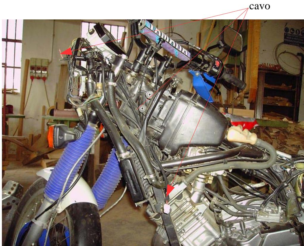
Si rimonta il serbatoio e si collega il cavo allo spinotto del rubinetto.
