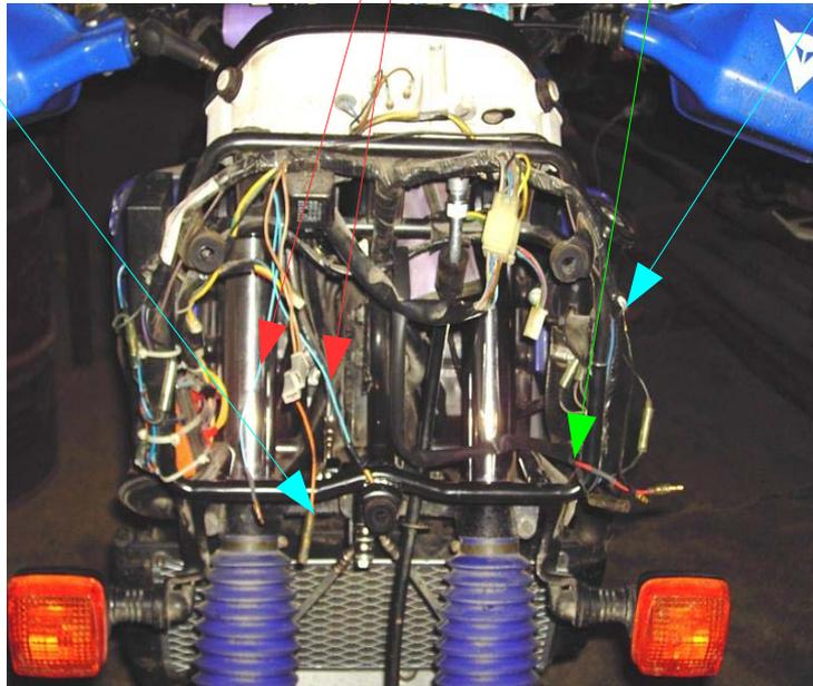
Si collega il POSITIVO a un cavo della spia l'altro cavo della spia si collega a un cavo del rubinetto, l'altro filo del rubinetto si collega a massa per i colori è lo stesso a vostro piacere. Fate un po d'ordine con i cavi mettendo qualche fascetta , lasciando del cavo libero per quando si dovrà smontare il serbatoio in futuro. Ora si può rimontare tutto partendo dai fari e le carene.
