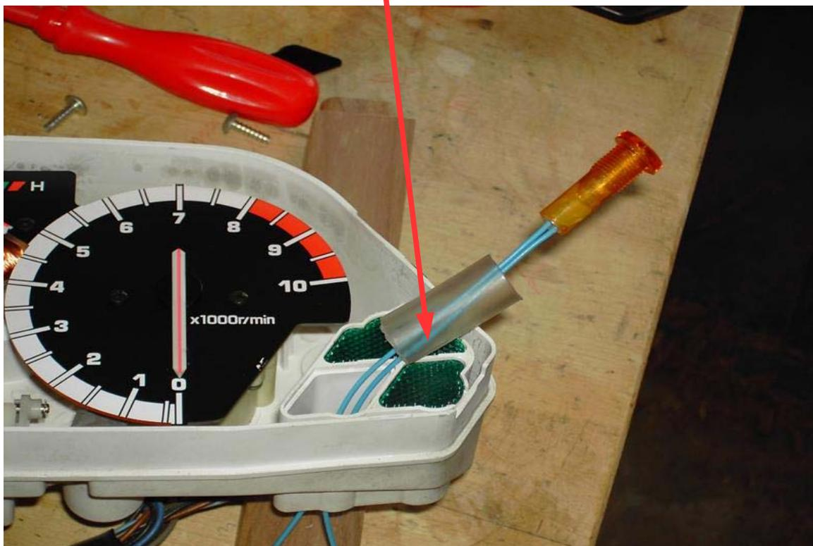
Si fa in modo con la lunghezza del tubetto che la spia sia allineata alla parte superiore dove c'era il coperchietto che chiudeva il foro. Negli spazi laterali che restano vuoti ho messo un po di silicone trasparente che tiene ben stabile la spia al centro. A questo punto si può richiudere il cruscotto con le 5 viti a croce, e riavvitare il pomello dell'azzeratore.
