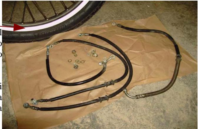
Mettendo le guarnizioni nuove, due per raccordo una sopra e una sotto, avvitate le viti alla pompa e alle pinze (per chi mantiene lo sdoppiatore, anche su quello) senza stringere.
