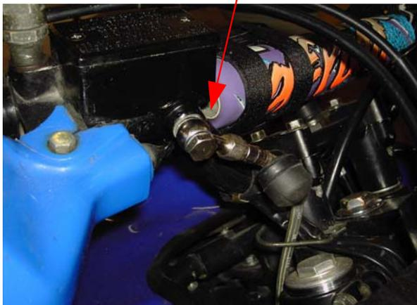
Al posteriore attenzione se dovete passare per l'archetto dentro al forcellone (XTZ 750) montate il gommino, nei kit sono già montati.
